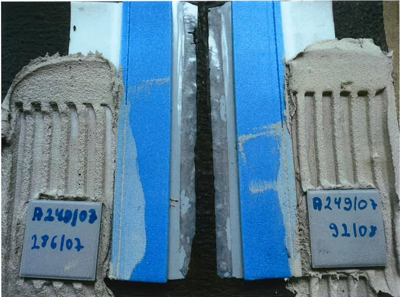
**Bild 3:** „ISOWATER®-FLEXZARGE® auf Primer in Verbindung mit Fliesenkleber
