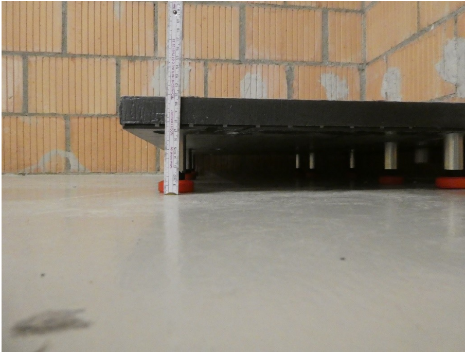
Abbildung 4: Prüfaufbau 1 mit Gesamtaufbauhöhe 118 mm
