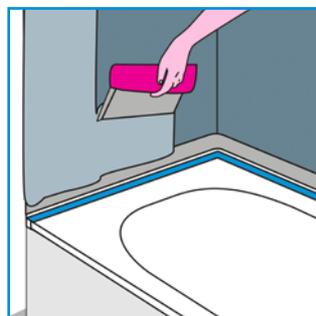
Aufgeklebtes Dichtband mit zweiter Verbundabdichtungsschicht überstreichen.
