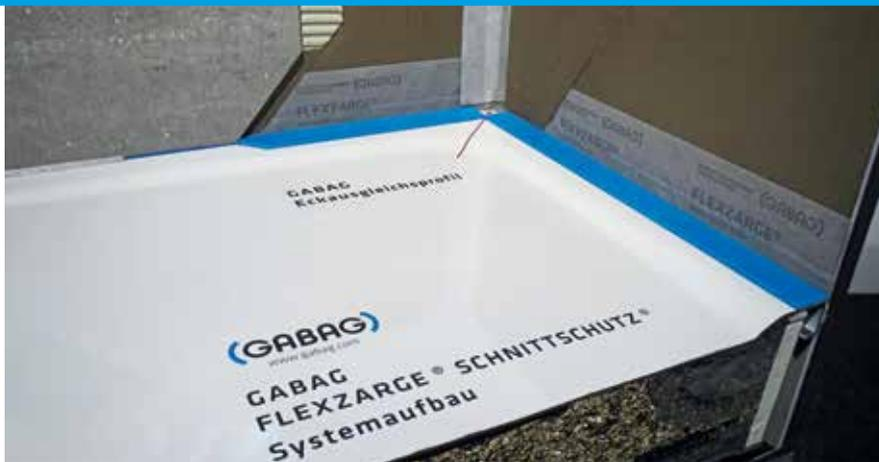
Alles in einem Band: Die „Gabag Flexzarge Schnitenschutz“ bietet neben dem Schallschutz zusätzlich eine temporäre Sekundärabdichtung rund um die Wannenränder. Im Falle einer defekten Silikonfuge können so Wasserschäden verhindert werden.
