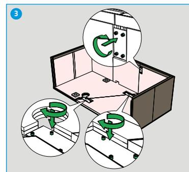
Far combaciare la seconda parte della WHIRLBOX® GABAG alla prima parte, e fissare le due parti con le viti verdi (sullo stesso punto come per lo smontaggio). Eventualmente far passare le linee di scarico, dei tubi reticolati e della corrente.
