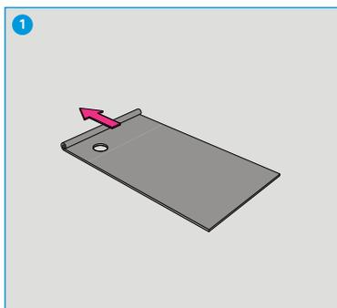
**CONTROLLARE LA SITUAZIONE COSTRUTTIVA:** la pavimentazione è piana? Le cavità della WHIRLBOX® GABAG si trovano al punto giusto? Il punto di installazione è pulito? Posare il tappetino nero insonorizzante su tutta la superficie di installazione a pavimento.
