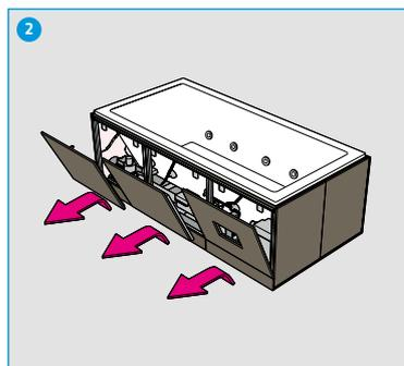
Aprire gli sportelli di revisione, sganciare le catenelle di fissaggio, estrarre con precauzione i segmenti e riporli singolarmente in sede di installazione.
