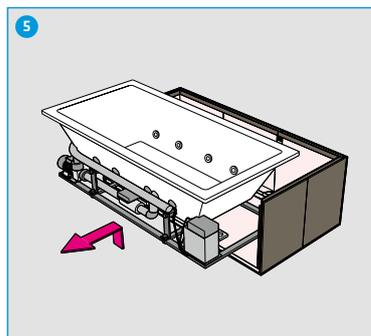
Sollevare con precauzione la vasca a idromassaggio ed estrarla anteriormente. Fare attenzione a non danneggiare i componenti dell'idromassaggio!
