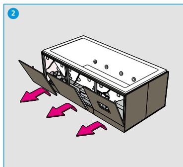
Ouvrir les trappes de maintenance, démonter les chaînes de maintien, enlever précautionneusement les différents segments puis les amener un à un sur le lieu du montage.
