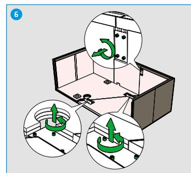
Le support GABAG WHIRLBOX® se compose de deux parties qui peuvent être séparées. Pour cela, dévisser les vis vertes au niveau du sol, sur les profils verticaux arrière et sur les surfaces de rangement.
