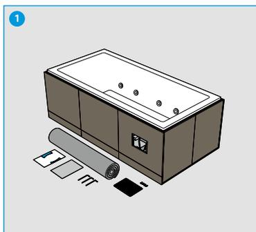
Le support GABAG WHIRLBOX® est toujours livré avec la baignoire (ajustement aux dimensions) en tant qu'unité complète. Pour faciliter le montage, il est nécessaire de démonter cette unité avant de la déplacer.
