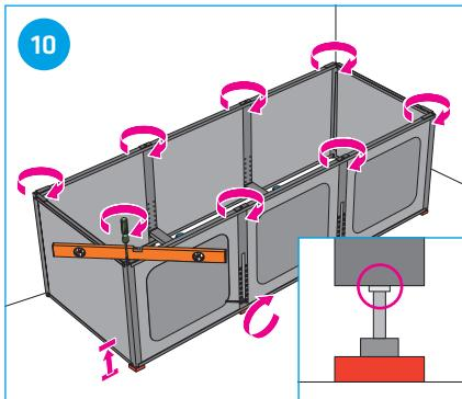
Usando un cacciavite a batteria e l'inserto fornito o un normale cacciavite, regolare l'altezza e livellare con precisione. Serrare il dado autobloccante.
