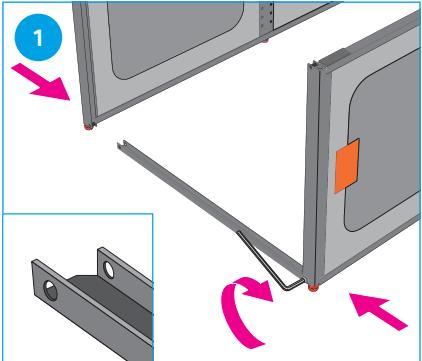
Visser les profils en U inférieurs (sans appui gris) aux deux éléments latéraux (côté chanfreiné vers l'intérieur).
