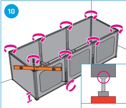
Mit Akku-Schrauber und mitgeliefertem Bit oder Schraubenzieher Höhe einstellen und exakt ausnivellieren. Kontermutter anziehen.
