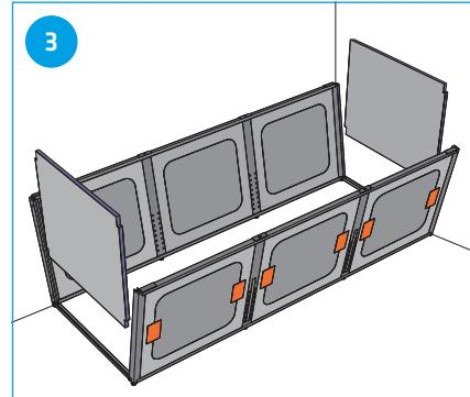
Pour pouvoir insérer l'élément de tête de la baignoire, il faut maintenir les éléments latéraux légèrement écartés avant de les presser de nouveau.
