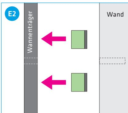
In unmittelbarer Nähe des Bohrloches zwei Distanzstücke aussen auf Wannenträger kleben.
