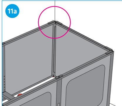
Um den korrekten Abstand zwischen Wannenträger und Wand zu gewährleisten, müssen zwei Distanzstücke montiert werden (Ecke zur Wand).
