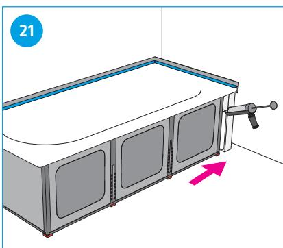
En cas de besoin, coller un élément de remplissage à fleur de la face avant du support de baignoire, entre le support de baignoire et le mur.
