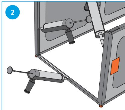
Montagekleber in Nut von Aluprofilen einbringen. Profile können von der Aussen- und Innenseite verschraubt werden.
