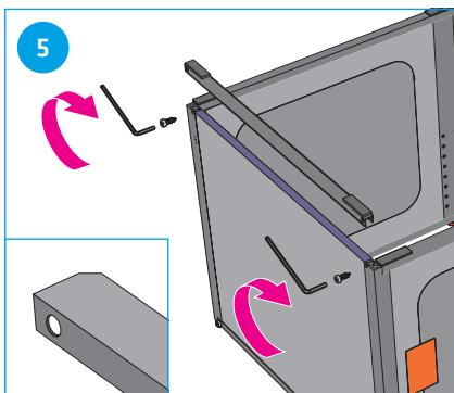
Coller le profil en U (côté chanfreiné vers l'intérieur) sur l'élément de tête de la baignoire puis le visser sur les éléments latéraux.
