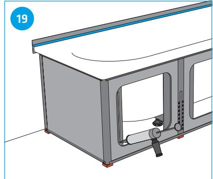
Appliquer la colle de montage sur le profil en aluminium plat ainsi que sur les arêtes de coupe.
