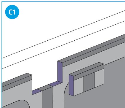
**TRÄGER IST ZU SCHMAL (ODER WANNE ZU BREIT) UM EINEN ÜBERLAUF (EXAFILL) ZU MONTIEREN, AN GLEICHER STELLE STEHT DANN AUCH NOCH DIE MITTELSTÜTZE IM WEG:** In diesem Falle Mittelstütze mit Stichsäge kürzen. (Sägeblatt für Stahl verwenden).
