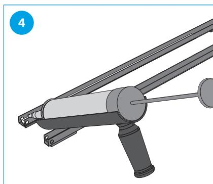
Montagekleber in obere U-Profile (mit grauer Auflage) einbringen.
