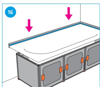
Incollare la vasca sul supporto, e controllare che rientri in modo omogeneo.
