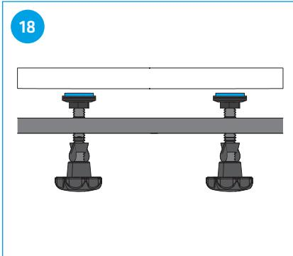
Remonter les pieds de soutien centraux jusqu'à ce qu'ils arrivent au niveau du fond de la baignoire. Ne pas soulever la baignoire ! Bloquer avec des écrous M8. Terminer la fixation de la baignoire.
