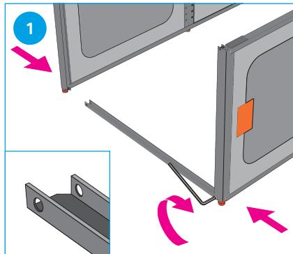
Prüfen ob Bodenfläche eben + sauber ist. Untere U-Profile (ohne grauer Auflage) mit den beiden Seitenteilen verschrauben (angeschrägte Seite zeigt nach Innen).
