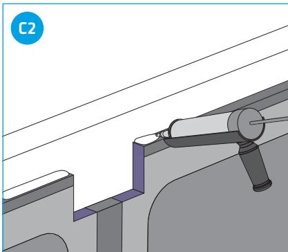
Retirer le caoutchouc gris de l'élément découpé à la scie, le couper en deux et recoller les deux morceaux à droite et à gauche de l'arête de coupe. Appliquer également de la colle de montage sur la face supérieure.
