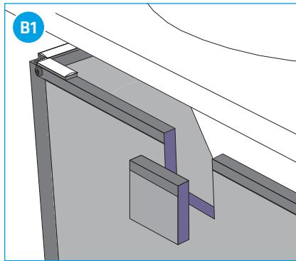
**TRÄGER IST ZU SCHMAL (ODER WANNE ZU BREIT) UM EINEN ÜBERLAUF (EXAFILL) ZU MONTIEREN:** In diesem Fall die Platte an entsprechender Stelle mit Messer oder Säge ausschneiden.
