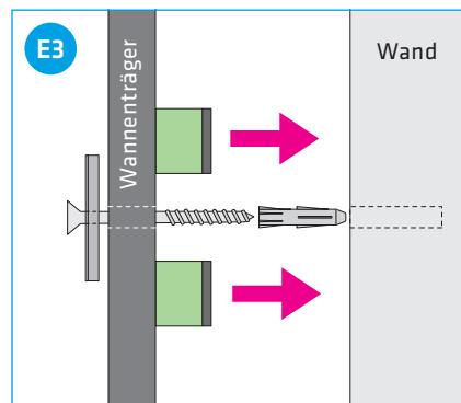
Schraube durch Rosette schieben und Dübel aufsetzen.
