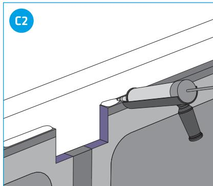
Grauer Gummi vom ausgesägten Stück lösen, halbieren, links und rechts der Schnittkannte wieder aufkleben. Montagekleber auch auf Oberseite aufbringen.
