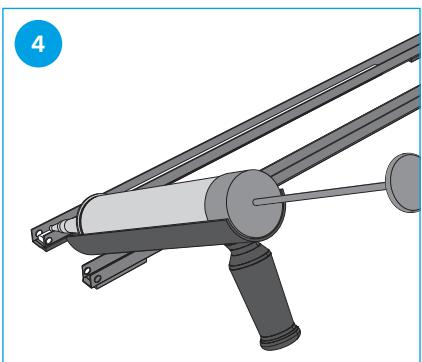
Appliquer la colle de montage dans les profils en U supérieurs (avec appui gris).
