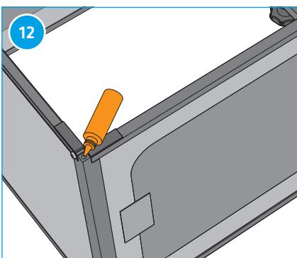
Inhalt der mitgelieferten kleinen Klebstoffflasche gleichmäßig in alle Öffnungen der Aluprofile füllen. Dies verhindert ein mögliches «klappern» der Gewindestangen im Aluprofil.
