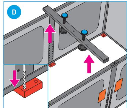
**SIPHON UND QUERSTREBE SIND AN GLEICHER STELLE:** In diesem Fall ist die Querstrebe zu demontieren und die beiden viereckigen Füsse sind mit dem Boden zu verschrauben.
