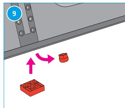
Schutzkappen auf Unterseite entfernen und Füsse montieren. **Beachten Sie:** Füsse für Ecken (mit einem Loch), Füsse für Mittelteile (mit zwei Löchern).
