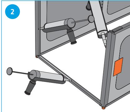
Appliquer la colle de montage dans la rainure des profils en aluminium. Les profils peuvent être vissés aussi bien de l'extérieur que de l'intérieur.
