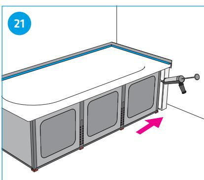
Se necessario incollare l'elemento riempitivo a filo con il lato anteriore del supporto vasca, tra supporto vasca e parete.
