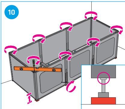
Régler la hauteur et effectuer la mise à niveau précise à l'aide d'une visseuse sans fil et de l'embout fourni ou bien d'un tournevis. Serrer les contre-écrous.
