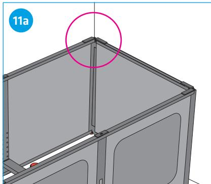
Pour garantir la distance correcte entre le support pour baignoires et le mur, il faut monter deux entretoises (dans le coin côté mur).
