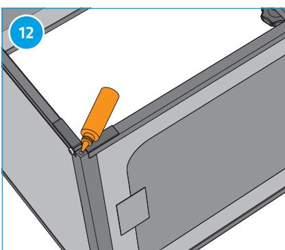
Remplir de façon uniforme toutes les ouvertures des profils en aluminium avec la colle du petit flacon fourni. Celle-ci va empêcher tout claquement des tiges filetées dans le profil en aluminium.
