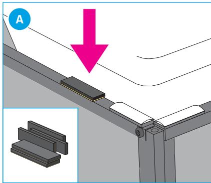
**WANNE WACKELT AUF DEM TRÄGER:** In diesem Fall sind Ausgleichsunterlagen zwischen Wanne und Träger zu kleben.
