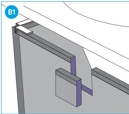
**LE SUPPORT EST TROP ÉTROIT (OU LA BAIGNOIRE TROP LARGE) POUR POUVOIR INSTALLER UN TROP-PLEIN (EXAFILL) :** dans ce cas, découper le carrelage à l'endroit correspondant à l'aide d'un couteau ou d'une scie.
