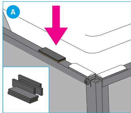
**LA BAIGNOIRE BOUGE SUR LE SUPPORT :** dans ce cas, il faut coller les cales de compensation sous la baignoire et sur le support.
