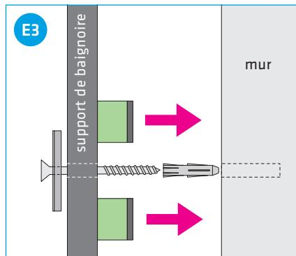
**FIXATION DU SUPPORT POUR BAIGNOIRE AU MUR :** Percer un trou Ø 8 mm dans le support pour baignoires et dans le mur, à l'endroit approprié, le plus près possible d'un profil en aluminium.
