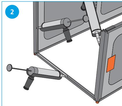
Applicare il collante di montaggio nella scanalatura dei profili di alluminio. È possibile avvitare i profili dal lato interno ed esterno.
