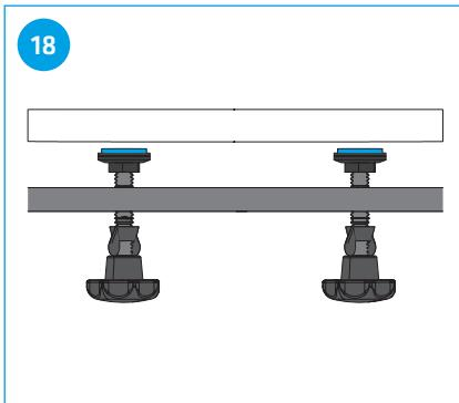
Avvitare i piedini del supporto centrale fino al fondo della vasca. Non sollevare la vasca! Serrare con le viti M8. Completare il raccordo della vasca.
