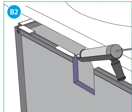
Se si taglia il profilo a U, quando si monta la vasca va applicato collante a sufficienza a destra e sinistra del bordo di taglio, direttamente sul profilo a U.
