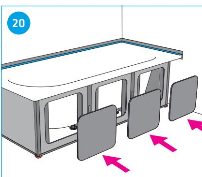
Incollare le coperture delle aperture di revisione e lasciar asciugare.
