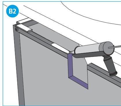
Lorsque le profil en U a été scié, il est important d'appliquer suffisamment de colle à droite et à gauche des arêtes de coupe du profil en U, lors du montage de la baignoire.
