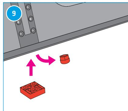
Asportare le protezioni dal lato inferiore e montare i piedini. **Si rammenta:** piedini per gli angoli (con un foro), piedini per gli elementi centrali (con due fori).
