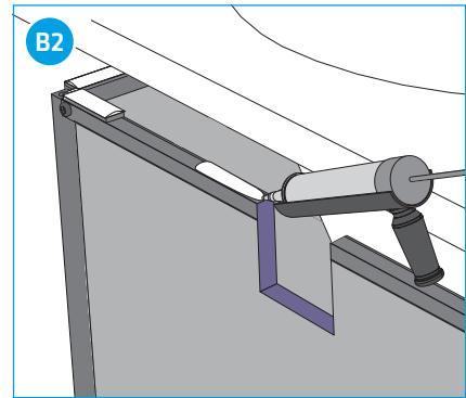
Bei durchgesägtem U-Profil ist bei der Montage der Wanne links und rechts der Schnittkannte genügend Kleber auf U-Profil aufzubringen.
