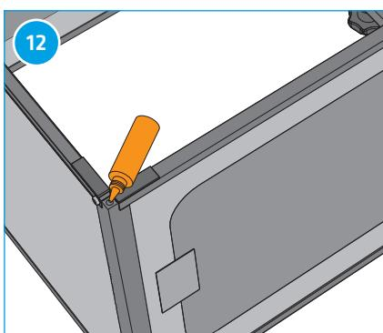
Applicare in modo omogeneo in tutte le aperture dei profili di alluminio il contenuto del tubetto piccolo di collante facente parte della fornitura. Ciò impedisce possibili «scosse» delle barre filettate nel profilo di alluminio.
