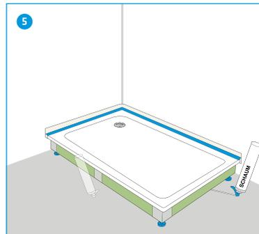
5 Duschenwannenträger bei Bedarf mit GABAG Klebefüllschaum vorsichtig unterschäumen.\*
