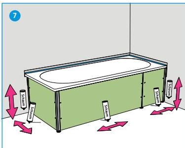
7 Bei Bedarf die Wand- und Bodenanschlüsse mit GABAG Klebefüllschaum ausfüllen.\* Kein Kontakt der Wanne mit Klebefüllschaum!
