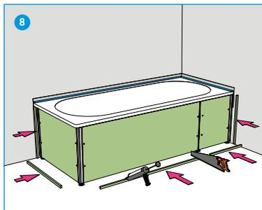
8 Füllstücke auf Mass zusägen und mit beiliegendem Montagekleber an Zwischenräume ankleben.\*
