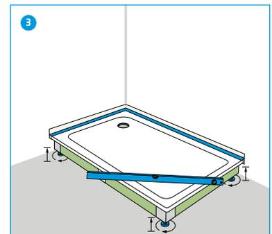
3 Wanne über die Schallschutzfüsse von Hand auf die gewünschte Höhe justieren und waagrecht ausrichten. TIPP: Vom Meterriss Einbauhöhe einmessen und Duschenwannenträgerhöhe voreinstellen.
