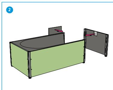
2 Wandseitige Verschlussplatte mit M6 Schrauben von innen an Badewannenträger befestigen. Fusseitiger Abschluss an Wannenträger mit M6 Schrauben von innen befestigen.
