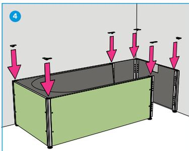
4 Abdeckung an Wannenträger anbringen (in Rohr stecken).
