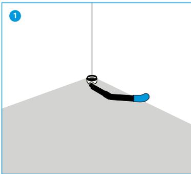
1 Kontrolle Nischenmass. Ablaufgarnitur an Ablaufleitung anschliessen und auf Position und Höhe der Duschenwanne ausrichten. Vor dem Versetzen am Wannenrand GABAG Wannenprofil ISOPHONE® oder GABAG FLEXZARGE® anbringen.
