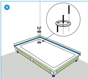
4 Siphon anschliessen und Dichtigkeitskontrolle durchführen.
