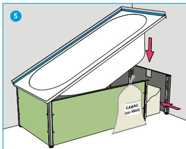
5 Vor dem Einlegen der Badewanne Ablaufgarnitur montieren und GABAG Wannenprofil ISOPHONE® oder GABAG FLEXZARGE® an den Wannenrand anbringen. Wanne einlegen und auf festen Sitz prüfen. Ablauf anschliessen und Dichtigkeitskontrolle durchführen. Montageöffnung mit GABAG ISO-WOLL ausstopfen.
