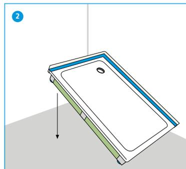
2 Ablaufleitung auf Boden des GABAG Duschenwannenträgers anzeichnen und Aussparung bei Rohrführungen wo nötig ausschneiden.
