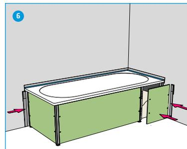
6 GABAG Frontverschluss am Wannenträger montieren (Detailzeichnung und Montageanleitung liegen bei). Schallschutzmatten zwischen Wannenträger und Wand anbringen.
