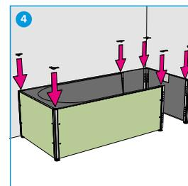
4 Abdeckung an Wannenträger anbringen (in Rohr stecken).
