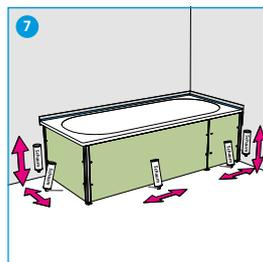
7 Bei Bedarf die Wand- und Bodenanschlüsse mit GABAG Klebefüllschaum ausfüllen.\* Kein Kontakt der Wanne mit Klebefüllschaum!
