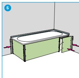
6 GABAG Frontverschluss am Wannenträger montieren (Detailzeichnung und Montageanleitung liegen bei). Schallschutzmatten zwischen Wannenträger und Wand anbringen.
