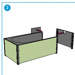
2 Wandseitige Verschlussplatte mit M6 Schrauben von innen an Badewannenträger befestigen. Fusseitiger Abschluss an Wannenträger mit M6 Schrauben von innen befestigen.
