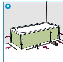
8 Füllstücke auf Mass zusägen und mit beiliegendem Montagekleber an Zwischenräume ankleben.\*
