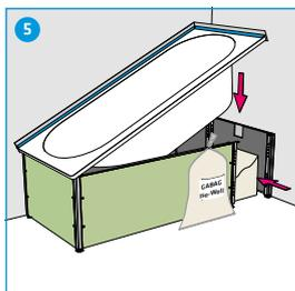
5 Vor dem Einlegen der Badewanne Ablaufgarnitur montieren und GABAG Wannprofil ISOPHONE® oder GABAG FLEXZARGE® an den Wannenrand anbringen. Wanne einlegen und auf festen Sitz prüfen. Ablauf anschliessen und Dichtigkeitskontrolle durchführen. Montageöffnung mit GABAG ISO-WOLL ausstopfen.
