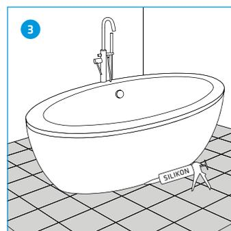
Piastrellare il pavimento, lasciando una fuga in silicone di ampiezza adeguata attorno al pannello della vasca.
