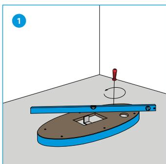
Posizionare la Silent Board® e, utilizzando le viti di regolazione e una livella a bolla, regolare a piombo. Avvitare solo temporaneamente nella cavità l'angolare di montaggio.
