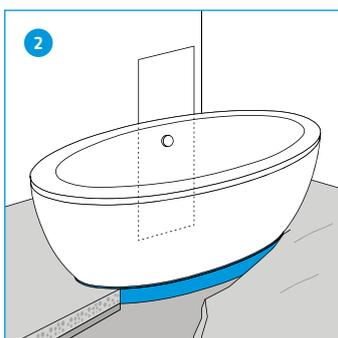
Posare il massetto. Poggiare la vasca, regolare eventualmente la sagoma per la cassetta e collegare allo scarico. Togliere l'angolare di montaggio.
