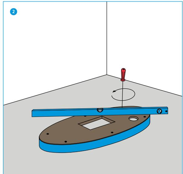
Silent Indoor Board® mit Wasserwaage über Stellschrauben ins Blei setzen.
