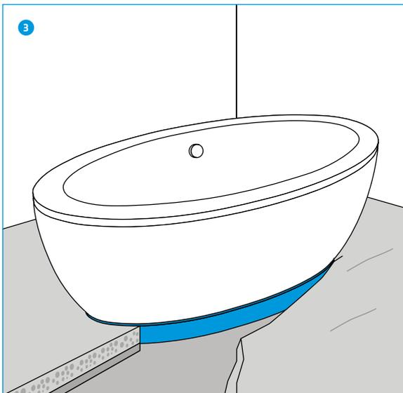
Unterlagsboden einbringen. Wanne aufsetzen und an Ablauf anschliessen.
