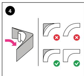
Choisir le profil de coin adapté au bord de la baignoire. Le profil de coin doit reposer à fleur du bord de la baignoire. Retirer le film de protection situé sur la face intérieure.
