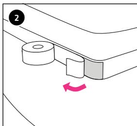
**Étanchéité verticale (au mur) avec rebord GABAG Flexzarge® :** Poser le ruban en butyle en un seul marceau à fleur du bord supérieur de la baignoire. Dans les coins de la baignoire, poser le ruban autour du rayon. Retirer le papier de protection.
