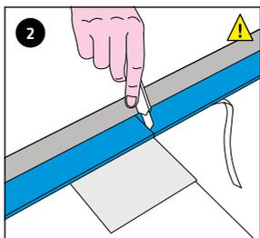
2 Couper le profil anti-bruit bleu sur le bord de la baignoire à l'aide d'un cutter. Placer en-dessous un morceau de carton afin de protéger la baignoire.
