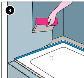
3 Recouvrir le ruban d'étanchéité collé d'une seconde couche d'étanchéification composite.
