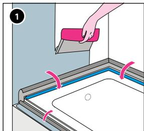
1 Rabattre le ruban d'étanchéité contrecollé de non-tissé en direction de la baignoire, puis appliquer l'étanchéification composite sur les surfaces de rangement côté murs.
