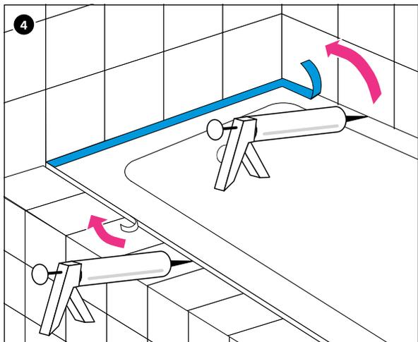
4 Une fois la pose du carrelage terminée, retirer le profil de protection de bord de baignoire bleu perforé et remplir largement le joint avec du silicone, par exemple Ottoseal® S100 ou similaire. L'élément résiduel fait office de joint de remplissage (cordon rond) et d'isolation phonique.
