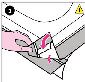
Suivre, pour toutes les surfaces horizontales à étanchéifier les étapes de montage 1 à 5. Retirer maintenant le ruban de protection sur la partie large de la bande adhésive grise.
