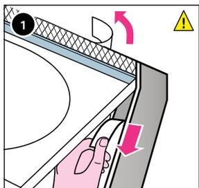
Retirer le ruban de protection sur la bande adhésive grise (partie étroite) puis poser le rebord GABAG FLEXZARGE® à fleur du bord supérieur. Retirez le ruban de protection (dans la même longueur) du rebord FLEXZARGE®.
