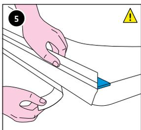
5 Retirer le film de protection du ruban adhésif en butyle gris. Bien presser le rebord FLEXZARGE® contre le bord de la baignoire avec le dos de la main, ou bien avec le rouleau presseur GABAG, en particulier au niveau des coins.
