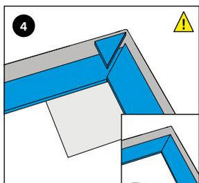
4 Couper le profil anti-bruit bleu en biais, enlever le matériau en trop, ainsi que la protection du bord de baignoire, puis continuer le montage du profil anti-bruit.
