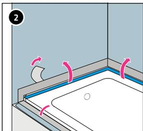
2 Retirer le papier de protection situé à l'arrière du ruban d'étanchéité, puis coller ce dernier sur l'étanchéification composite sèche. Poser le ruban d'étanchéité sur l'étanchéification, de manière bien plane et en évitant les inclusions d'air.
