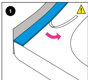
1 Poser le rebord GABAG Flexzarge® avec un angle de 90° à fleur du bord de la baignoire. Retirer le film de protection dessous du profilé.
