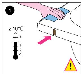
Bien frotter le pourtour de la baignoire avec un chiffon de nettoyage (humide), laisser aérer 3 minutes puis essuyer avec un chiffon sec : contrôler l'adhérence de la colle avec la bande de test adhésive. Ne pas utiliser sur des surfaces sensibles.
