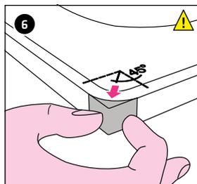
6 Posare il profilo angolare sul bordo vasca con angolo a 45°. Posare solo dove successivamente si applica il nastro FLEXZARGE®. Asportare la pellicola protettiva sul lato esterno.
