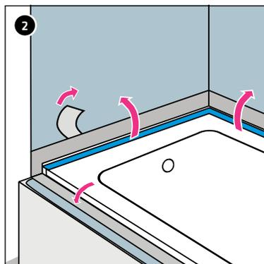
2 Staccare la carta di protezione sul retro del nastro di tenuta e incollare sulla tenuta ermetica asciutta. Applicare il nastro di tenuta ben piatto e senza bolle d'aria sulla tenuta ermetica.
