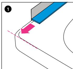
1 Posare il nastro GABAG FLEXZARGE® con angolo di 90° rispetto al bordo vasca. Il nastro FLEXZARGE® deve risultare a filo del bordo vasca.
