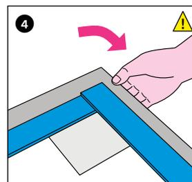
4 Posare il nastro FLEXZARGE® a spigolo vivo lungo il profilo angolare.
