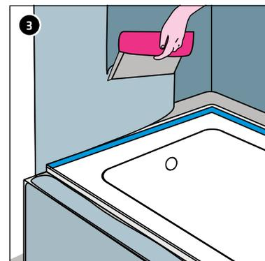
3 Applicare una seconda mano di tenuta ermetica sul nastro di tenuta incollato.
