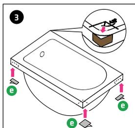
3 A seconda della situazione costruttiva, applicare sotto il bordo vasca gli angolari di raccordo **E** e premere accuratamente.
