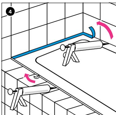
4 Dopo la posa delle piastrelle, staccare il profilo blu perforato di protezione del bordo vasca e applicare nella fuga in quantità adeguata un silicone, ad es. Ottoseal® S100 o un prodotto analogo. Il pezzo residuo funge da profilo di riempimento (cordoncino) e disaccoppiamento insonorizzante.
