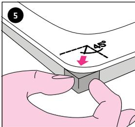
5. Eckausgleichsprofil im 45° Winkel an den Wannenrand anbringen. Nur dort wo später die FLEXZARGE® angebracht wird. Abdeckfolie auf Aussenseite entfernen.
