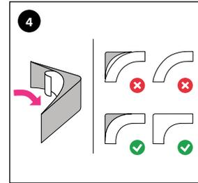
4. Das passende Eckausgleichsprofil für den Wannenrand auswählen. Eckprofil muss bündig am Wannenrand liegen. Abdeckfolie auf Innenseite entfernen.
