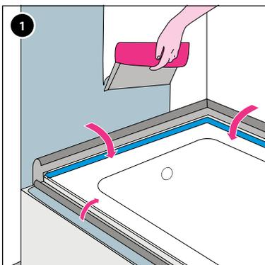
Dichtband in Richtung Wanne herunterklappen und Verbundabdichtung auf Wand auftragen.
