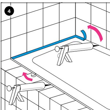
Nach Verfliesen perforiertes, blaues Wannenrandschutzprofil abziehen und Fuge genügend breit mit Silikon ausarbeiten. z. B. Ottoseal® S100 oder gleichwertig. Reststück dient als Fugenhinterfüllung (Rundschnur) und Schallkoppelung.
