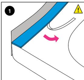
1. FLEXZARGE® bündig Wannenrand im 90° Winkel montieren. Abdeckpapier auf Unterseite Wannenrandschutzprofils abziehen.
