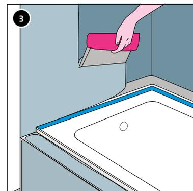
Aufgeklebtes Dichtband mit zweiter Verbundabdichtungsschicht überstreichen.
