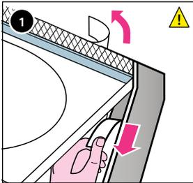
1 Klebestreifen-Deckband vom grauen schmalen Kleber abziehen und bündig Oberkante GABAG FLEXZARGE® montieren. Das Deckband der FLEXZARGE® ist um die gleiche Fläche abzu- ziehen.
