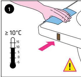
1. Wannenrand mit Reinigungstuch (feucht) gut abreiben, 3 Minuten ablüften lassen und mit Trockentuch nachwischen: Kleberhaftung mit Testklebestreifen prüfen. Nicht auf empfindlichen Oberflächen anwenden.
