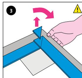
3. FLEXZARGE® scharfkantig um das Eckprofil legen. Blaues Schallschutzprofil in Gehrung schneiden und Reststücke und Wannenrandschutz entfernen.
