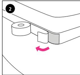
2. **Vertikale Abdichtung (zur Wand):** mit FLEXZARGE®: Butylband in einem Stück an der Seitenflanke bündig Oberkante des Wannenrandes anbringen. Bei der Ecke der Wanne rund um den Radius legen. Schutzfolie entfernen.
