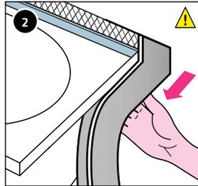
2 Grauen schmalen Kleber bündig unter Wannenrand montieren und gut anpressen.
