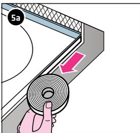
5a Das weiße Schallentkoppelungs- profil (3x30mm, perforiert) **a** auf dem Wannenrandumbug bei der Horizontalabdichtung montieren..
