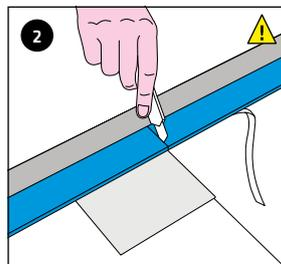
2. Mit Cutter blaues Schallschutzprofil am Wannenrand einschneiden. Als Schutzunterlage ein Stück Karton darunter legen.
