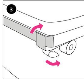
3. **Variante 1 – Horizontale Abdichtung (bei Simsen / Podesten):** mit Horizontaldichtband: Butylband in einem Stück Oberkante des vertikalen Butylstreifen und unter Wannenrand bündig Wannenkante anbringen. Bei den Ecken überlappen.
