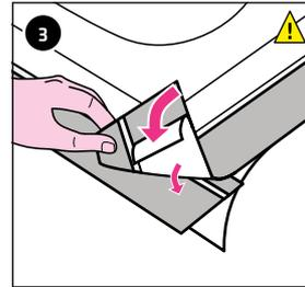
3 Bei sämtlichen horizontal ab- zudichtenden Flächen sind die Montageschritte 1 bis 5 zu be- folgen. Abdeckband vom breiten grauen Kleber lösen.
