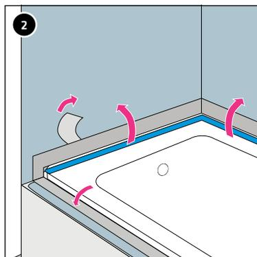
Abdeckpapier auf der Rückseite des Dichtbandes abziehen und auf getrocknete Verbundabdichtung aufkleben. Das Dichtband plan ohne Lufteinschluss auf Abdichtung aufbringen.
