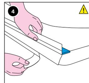
4. Abdeckfolie vom grauen Butylband an der FLEXZARGE® abziehen und mit Handrücken oder GABAG Anpressrolle gut an Wannenrand pressen, insbesondere die Ecken und Übergänge.
