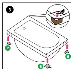
Suivant la situation de montage, il peut être nécessaire de poser (en pressant fortement) des raccords d'angles **E** sous le bord de la baignoire.
