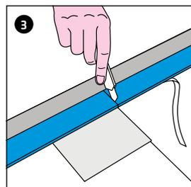
Couper le profil anti-bruit bleu sur le bord de la baignoire à l'aide d'un cutter. Placer en-dessous un morceau de carton afin de protéger la baignoire.
