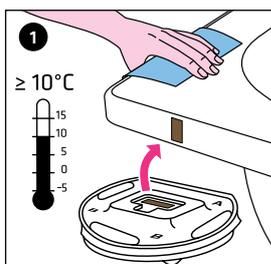
Bien frotter le pourtour de la baignoire avec un chiffon de nettoyage (humide), laisser aérer 3 minutes puis essuyer avec un chiffon sec : contrôler l'adhérence de la colle avec la bande de test adhésive. Ne pas utiliser sur des surfaces sensibles.
