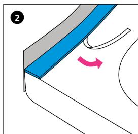
Retirer le papier de protection situé sur la face inférieure et bien presser le rebord FLEXZARGE® contre la baignoire.
