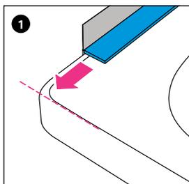
Maintenir le rebord GABAG FLEXZARGE®, avec un angle de 90°, contre le bord de la baignoire. Le rebord FLEXZARGE® doit arriver à fleur du bord de la baignoire.
