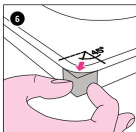
Placer le profil de coin, avec un angle de 45°, contre le bord de la baignoire. Uniquement là où, plus tard, le rebord FLEXZARGE® sera posé. Retirer le film de protection situé sur la face extérieure.
