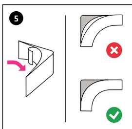
Choisir le profil de coin adapté au bord de la baignoire. Le profil de coin doit reposer à fleur du bord de la baignoire. Retirer le film de protection situé sur la face intérieure.
