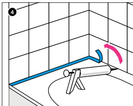
4 Dopo la posa delle piastrelle, staccare il profilo blu perforato di protezione del bordo vasca e applicare nella fuga in quantità adeguata un silicone, ad es. Ottoseal® S100 o un prodotto analogo. Il pezzo residuo funge da profilo di riempimento (cordoncino) e disaccoppiamento insonorizzante.
