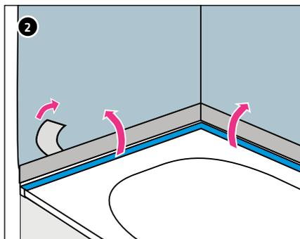
2 Staccare la carta di protezione sul retro del nastro di tenuta e incollare sulla tenuta ermetica asciutta. Applicare il nastro di tenuta ben piatto e senza bolle d'aria sulla tenuta ermetica.
