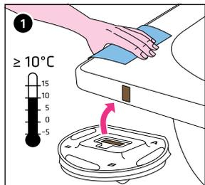
Pulire accuratamente il bordo della vasca con un panno (inumidito), arieggiare per 3 minuti e ripassare con un panno asciutto: controllare con le strisce adesive di test la presa del collante. Non utilizzare su superfici delicate.
