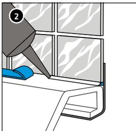
Dopo la posa delle piastrelle, staccare il profilo blu perforato dal nastro di tenuta e applicare nella fuga in quantità adeguata un silicone, ad es. Ottoseal® S100 o un prodotto analogo. Il pezzo residuo funge da profilo di riempimento (cordoncino) e disaccoppiamento insonorizzante.
