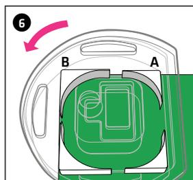
Ogni set contiene due profili angolari, il tipo A per raggi di curvatura vasca piccoli e il tipo B per raggi di curvatura grandi.
