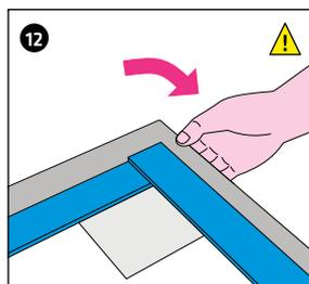
Posare il nastro FLEXZARGE® a spigolo vivo lungo il profilo angolare.
