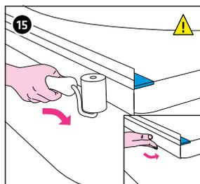
Premere accuratamente sul bordo vasca il nastro FLEXZARGE®, con il dorso della mano o con il rullo di pressione GABAG, particolarmente sugli angoli. Incollare il nastro di butile sporgente sotto il bordo vasca.
