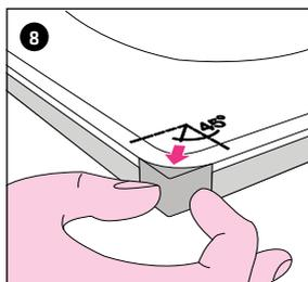
Posare il profilo angolare sul bordo vasca con angolo a 45°. Posare solo dove successivamente si applica il nastro FLEXZARGE®. Asportare la pellicola protettiva sul lato esterno.
