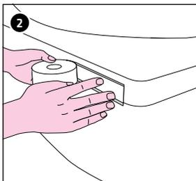
Posare in un solo pezzo il nastro in butile a filo del bordo superiore del bordo vasca. Sugli angoli della vasca posarlo attorno alla curvatura. Installare il nastro in butile solo dove successivamente si applica il nastro GABAG FLEXZARGE®.
