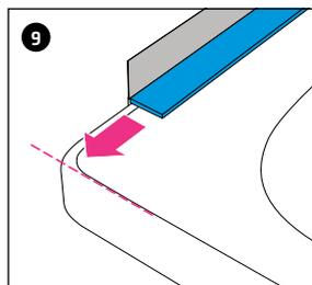
Posare il nastro GABAG FLEXZARGE® con angolo di 90° rispetto al bordo vasca. Il nastro FLEXZARGE® deve risultare a filo del bordo vasca.
