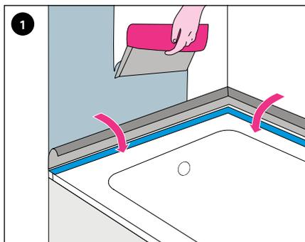
1 Replier le ruban d'étanchéité recouvert d'un non-tissé vers la baignoire, puis appliquer l'étanchéification composite sur le mur.
