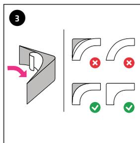
Choisir le profil des coins adapté au bord de la baignoire. Le profil des coins doit reposer à fleur du bord de la baignoire. Retirer le film de protection situé sur la face intérieure.
