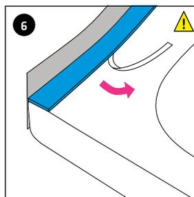
Maintenir le rebord GABAG FLEXARGE®, avec un angle de 90°, contre le bord de la baignoire. Retirer le papier de protection situé sur la face inférieure et bien presser le rebord FLEXARGE® contre la baignoire.
