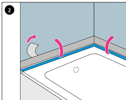
2 Retirer le papier de protection situé à l'arrière du ruban d'étanchéité, puis coller ce dernier sur l'étanchéification composite sèche. Poser le ruban d'étanchéité sur l'étanchéification, de manière bien plane et en évitant les inclusions d'air.
