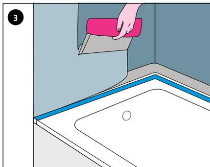
3 Recouvrir le ruban d'étanchéité collé d'une deuxième couche d'étanchéification composite.
