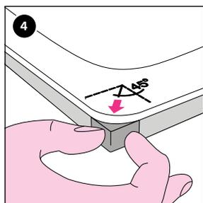
Placer le profil de coin, avec un angle de 45°, contre le bord de la baignoire. Uniquement là où, plus tard, le rebord FLEXARGE® sera posé. Retirer le film de protection situé sur la face extérieure.
