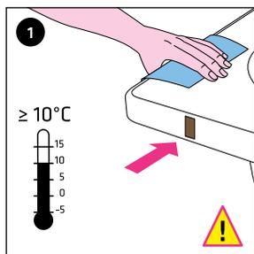
Bien frotter le pourtour de la baignoire avec un chiffon de nettoyage (humide), laisser aérer 3 minutes puis essuyer avec un chiffon sec: contrôler l'adhérence de la colle avec la bande de test adhésive. Ne pas utiliser sur des surfaces sensibles.
