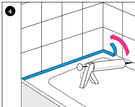
4 Une fois la pose du carrelage terminée, retirer le profil de protection de bord de baignoire et remplir largement le joint de silicone, par exemple Ottoseal® S100 ou similaire. L'élément résiduel fait office de joint de remplissage (cordon rond) et d'isolation phonique.
