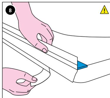
Abdeckfolie vom grauen Butylband an der FLEXZARGE® abziehen und mit Handrücken oder GABAG Anpressrolle gut an Wannenrand pressen, insbesondere die Ecken und Übergänge.
