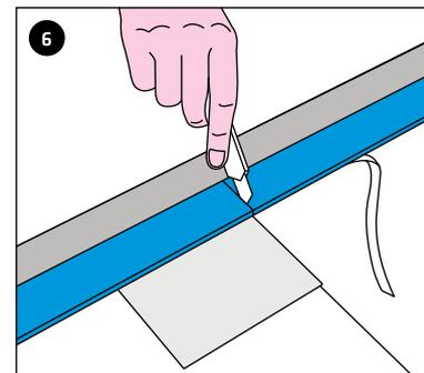
Mit Cutter blaues Schallschutzprofil am Wannenrand einschneiden. Als Schutzunterlage ein Stück Karton darunter legen.
