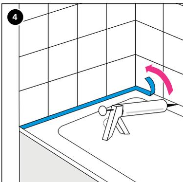
4 Nach Verfliesen perforiertes, blaues Wannenrandschutzprofil abziehen und Fuge genügend breit mit Silikon ausarbeiten. z. B. Otoseal® S100 oder gleichwertig. Reststück dient als Fugenhinterfüllung (Rundschnur) und Schallkoppelung.
