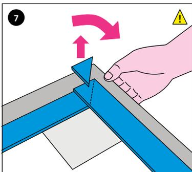
FLEXZARGE® scharfkantig um das Eckprofil legen. Blaues Schallschutzprofil in Gehung schneiden und Reststücke und Wannenrandschutz entfernen.
