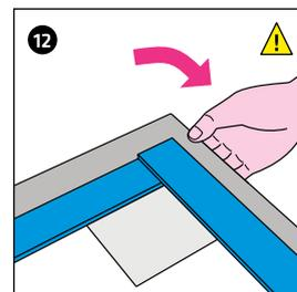
12 Posare il nastro FLEXZARGE® a spigolo vivo lungo il profilo angolare.
