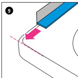
9 Posare il nastro FLEXZARGE® GABAG con angolo di 90° rispetto al bordo vasca. Il nastro FLEXZARGE® deve risultare a filo del bordo vasca.
