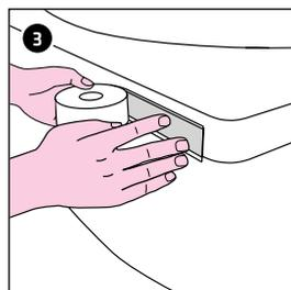
3 Posare in un solo pezzo il nastro in butile a filo del bordo superiore del bordo vasca. Sugli angoli della vasca posarlo attorno alla curvatura. Installare il nastro in butile solo dove successivamente si applica il nastro FLEXZARGE® GABAG.
