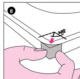
8 Posare il profilo angolare sul bordo vasca con angolo a 45°. Posare solo dove successivamente si applica il nastro FLEXZARGE®. Asportare la pellicola protettiva sul lato esterno.
