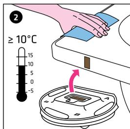
2 Pulire accuratamente il bordo della vasca con un panno (inumidito), arieggiare per 3 minuti e ripassare con un panno asciutto: controllare con le strisce adesive di test la presa del collante. Non utilizzare su superfici delicate.
