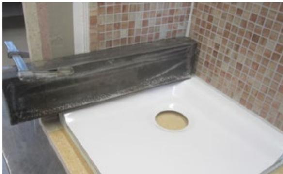
Dopo l'essiccamento si è applicato per 10 giorni sul bordo della vasca il carico previsto, utilizzando il profilo di acciaio pieno.
