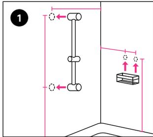
Définir la position de montage de la garniture. **IMPORTANT:** Pas de structure-support nécessaire derrière le trou.
