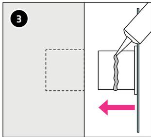
Nettoyer la zone à coller sur l'aide au montage Fixbox à encastrer. Appliquer la colle au centre de la Fixbox à encastrer, puis l'enfoncer dans le trou.
