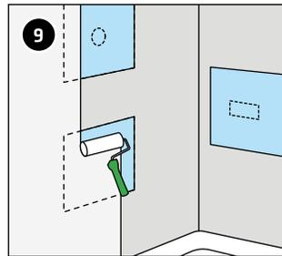
Appliquer l'étanchéification composite sur le mur en y incorporant le non-tissé pré-installé. Observer les indications du fournisseur.
