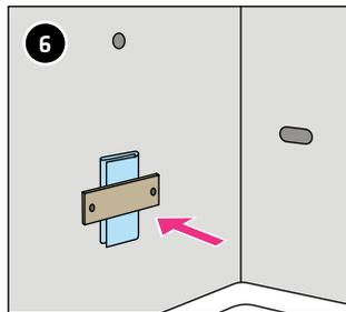
Poser le dispositif de fixation à vis.
