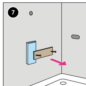
Lasciar asciugare per circa 1 ora. (L'adesivo si gonfia). Dopo che la colla si è indurita, rimuovere le viti e il dispositivo di fissaggio.
