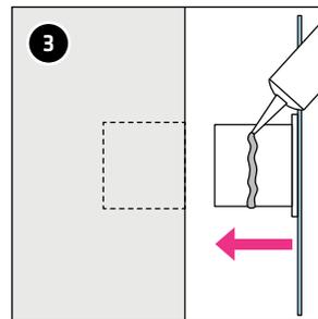
Pulire la zona da incollare sulla UP Fixbox. Applicare la colla al centro della UP Fixbox e premerlo nel foro.
