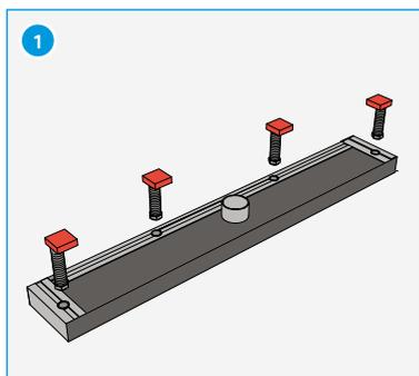
Accorciare le barre filettate in base all'altezza di montaggio, avvitarle nella struttura portante della canalina doccia e montare l'elemento di scarico.
