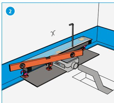
Tagliare le strisce di posizionamento in base alle dimensioni del tappetino insonorizzante. Livellare la canalina doccia all'altezza di montaggio. Tenere conto del rivestimento per la pendenza!
