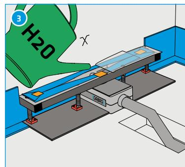
Tagliare le strisce di posizionamento dietro la canalina doccia, collegare allo scarico e controllare la tenuta. (Per motivi legati all'insonorizzazione, si deve isolare lo scarico e riempire la cavità)
