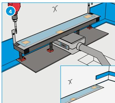
Fissare a parete gli angolari ausiliari di montaggio. Applicare il materiale di rivestimento per la pendenza (ad es. il sistema Mapei), asportare gli angolari di montaggio e la parte sporgente delle le strisce di posizionamento.
