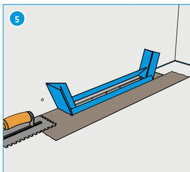
Applicare lo strato di tenuta ermetica rispettando le indicazioni del produttore e inserire la guarnizione di tenuta nello strato di tenuta ermetica (ad es. il sistema Mapei).
