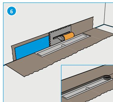
Sigillare l'intera superficie della doccia, seguendo le indicazioni del produttore. Incollare il nastro di protezione antitaglio. Dopo aver piastrellato la doccia, montare la copertura della canalina.
