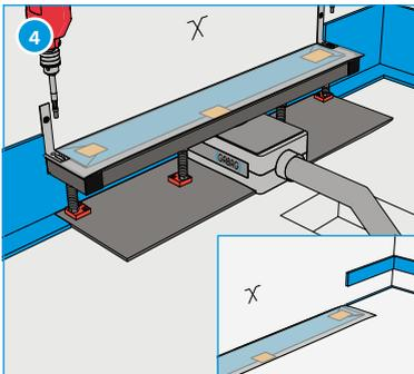
4 Winkel für Montagehilfe an Wand befestigen. Gefällsüberzug einbringen (z.B. System Mapei). Montagewinkel und überstehender Stellstreifen entfernen.
