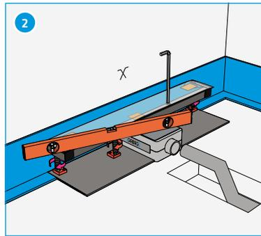
2 Stellstreifen entsprechend der Grösse der Schallentkoppelungsmatte ausschneiden. Duschrinne auf Einbauhöhe ausnivellieren. Gefällsüberzug berücksichtigen!
