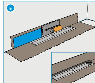
6 Die komplette Duschfläche abdichten gemäss Herstellerangaben. Schnittschutzband aufkleben. Wenn Dusche fertig gefliest ist, Rinnenabdeckung montieren.
