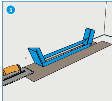
5 Verbundabdichtung gemäss Herstellerangaben verwenden und Dichtmanschette in Verbundabdichtung einarbeiten (z.B. System Mapei).
