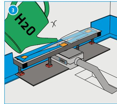
3 Stellstreifen hinter Duschrinne ausschneiden, Duschrinne an Ablauf anschliessen und auf Dichtheit prüfen (aus Schallschutztechnischen Gründen ist der Ablauf zu isolieren und die Aussparung aufzufüllen).
