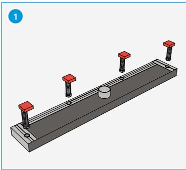
1 Gewindestangen entsprechend Einbauhöhe kürzen, in Duschrinnenkörper einschrauben und Ablaufkörper montieren.
