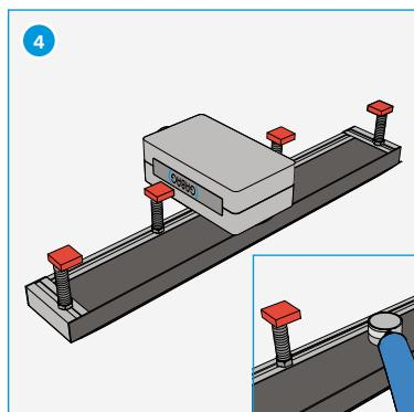
Lubrifier la rigole d'écoulement, puis monter l'élément d'écoulement.
