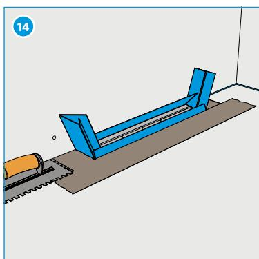
Verbundabdichtung gemäss Herstellerangaben verwenden und Dichtmanschette in Verbundabdichtung einarbeiten (z.B. System Mapei).
