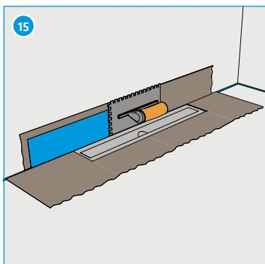
Etanchéifier l'ensemble de la surface de la douche, conformément aux indications du fabricant.
