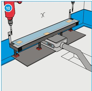
Winkel für Montagehilfe an Wand und Duschrinnenkörper befestigen.
