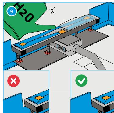
Raccorder la rigole de douche au système d'écoulement et contrôler l'étanchéité. La rigole de douche doit arriver à fleur du mur du fond et de la bande de positionnement.\*
