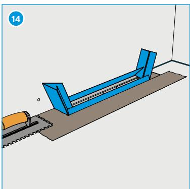
Appliquer une couche d'étanchéification composite, conformément aux indications du fabricant et intégrer le manchon d'étanchéité dans la couche d'étanchéification composite (par exemple : système Mapei).
