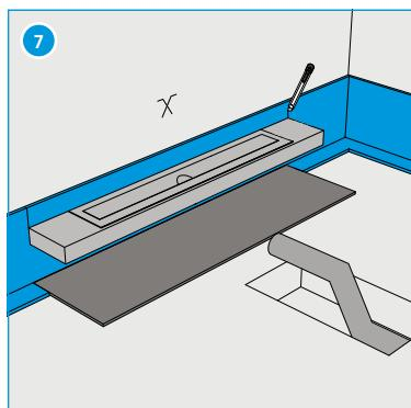
Découper la bande de positionnement derrière la rigole de douche et la retirer.
