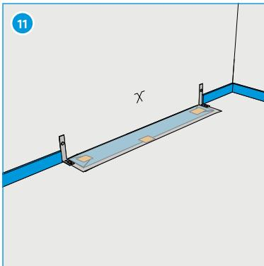
Applicare il materiale di rivestimento per la pendenza (ad es. il sistema Mapei).
