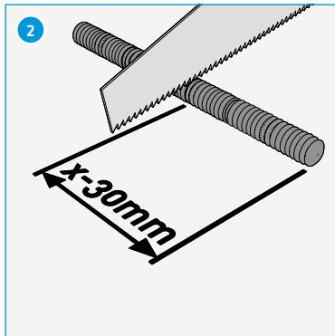
Accorciare adeguatamente le barre filettate. Altezza di montaggio -30 mm.
