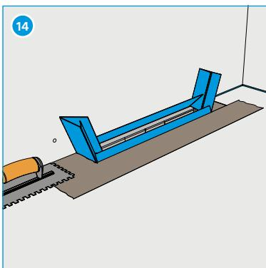
Applicare lo strato di tenuta ermetica rispettando le indicazioni del produttore e inserire la guarnizione di tenuta nello strato di tenuta ermetica (ad es. il sistema Mapei).
