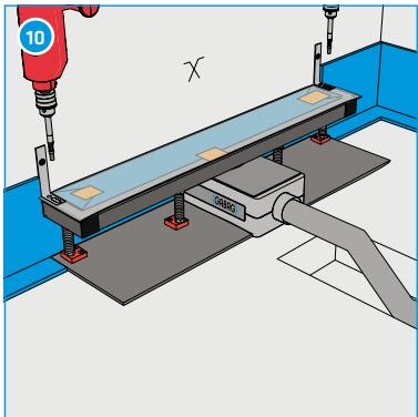
Fixer les cornières d'aide au montage au mur et au corps de la rigole.
