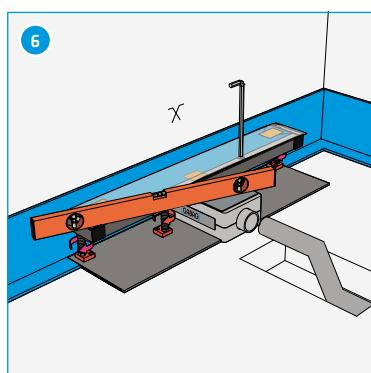
Livellare la canalina doccia all'altezza di montaggio. Tenere conto del rivestimento per la pendenza!
