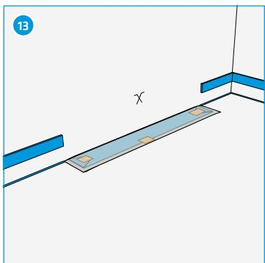
Asportare la parte sporgente delle strisce di posizionamento.
