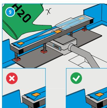
Collegare la canalina doccia allo scarico e controllare la tenuta. La canalina doccia deve essere posizionata a filo di parete posteriore e strisce di posizionamento.\*
