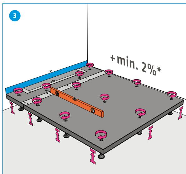
Regolare dall'alto il pavimento doccia GABAG usando la chiave a brugola. Impostare una pendenza minima di +2% e inserire la protezione canalina.
