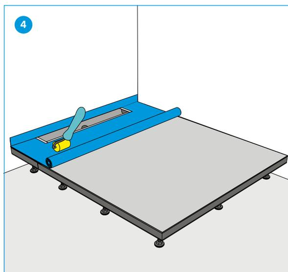
Dopo aver fissato i piedini insonorizzanti regolabili in altezza con Loctite e aver avvitato le viti di tenuta, applicare il collante di montaggio GABAG su tutta la superficie del pavimento doccia e stendere con una cazzuola. Incollare senza pieghe e ondulazioni il nastro ermetico fornito.
