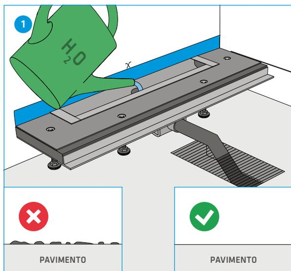
Inserire a tenuta l'elemento di scarico sul bocchettone della canalina di scarico. Collegare elemento di scarico e tubo di scarico e controllarne la tenuta. Evitare un contatto tra elemento di scarico e pavimento. (Per motivi legati all'insonorizzazione, si deve isolare lo scarico e riempire la cavità)
