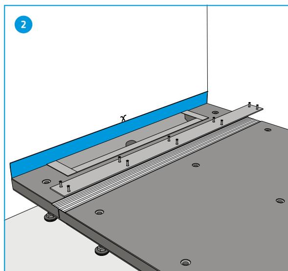
Poggiare l'elemento della doccia sul pezzo a canalina. Applicare il collante di montaggio GABAG fornito su tutta la cavità fresata e stendere con una cazzuola. Poggiare dall'alto la placchetta metallica e avvitare.
