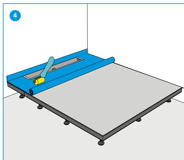
Une fois les pieds anti-bruit réglables en hauteur sécurisés avec de la Loctite et les vis d'étanchéité vissées, recouvrir toute la surface du support douche de sol GABAG avec la colle de montage GABAG, puis lisser avec une spatule. Coller la bande d'étanchéité fournie, en faisant attention à ce qu'elle n'ondule pas et à ce qu'elle ne forme pas de vagues.
