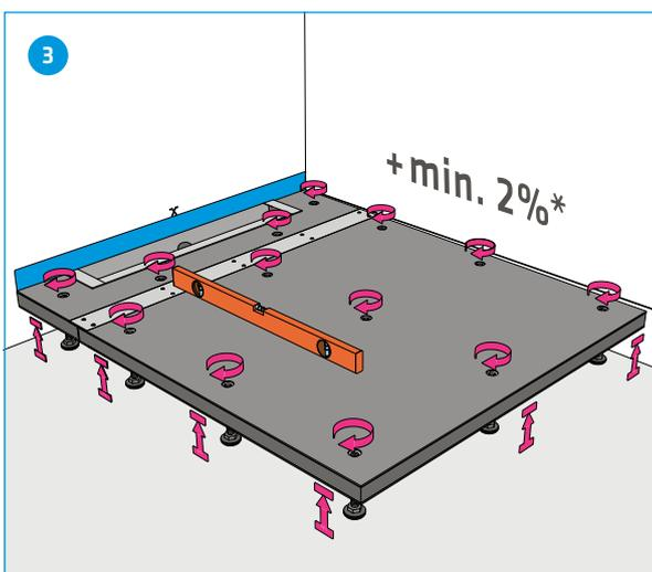
Ajuster ensuite le support douche de sol GABAG par le haut à l'aide d'une clé Allen. Régler une pente de 2% min. puis monter la protection des conduites. \*La pente dépend du carrelage choisi
