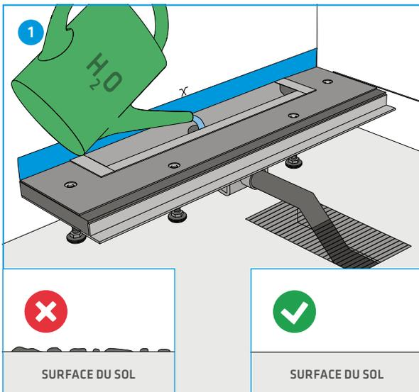
Monter l'élément d'écoulement de manière à ce qu'il arrive à fleur du manchon de la conduite d'écoulement. Raccorder l'élément d'écoulement sur la conduite d'écoulement et vérifier l'étanchéité. Eviter tout contact entre l'élément d'écoulement et le sol. (Pour des raisons techniques d'isolation anti-bruit, il faut isoler l'écoulement et remplir les trous d'isolant)
