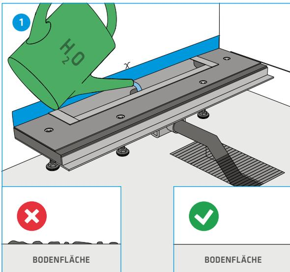
Ablaufkörper auf Stützen der Ablaufrinne satt aufstecken. Ablaufkörper an Ablaufrohr anschliessen und auf Dichtigkeit prüfen. Kontakt Ablaufkörper und Boden ist zu vermeiden. (Aus schallschutztechnischen Gründen ist der Ablauf zu isolieren und die Aussparung aufzufüllen)
