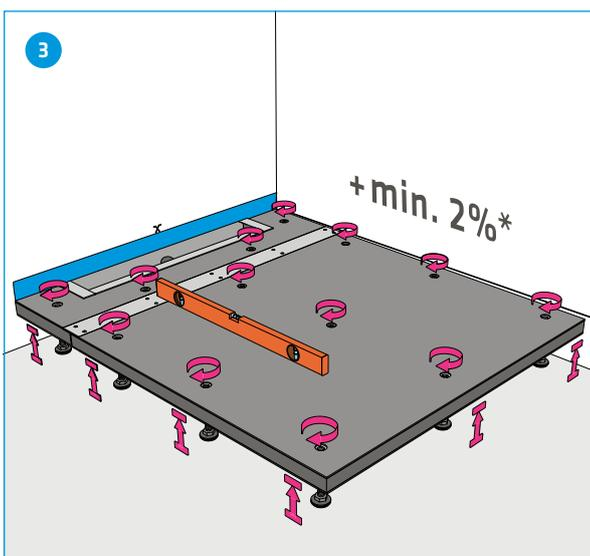
GABAG Duschboden von oben mit dem Inbusschlüssel nachjustieren. Gefälle von min. 2% einstellen und Rinnenschutz einlegen.
