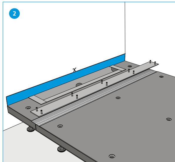
Duschbodenteil auf Rinnenteil legen. Mitgelieferter GABAG Montagekleber vollflächig über die Ausfräsung aufbringen und mit einem Spachtel abziehen. Metallplatte von oben auflegen und verschrauben.
