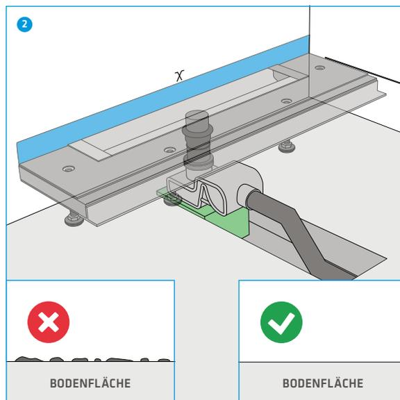
Verschiedene Einbauvarianten je nach Montagesituation und Aussparungshöhe. (Aus schallschutztechnischen Gründen ist der Ablauf zu isolieren und die Aussparung aufzufüllen)
