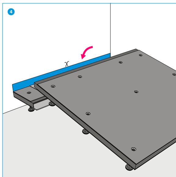
Duschboden-Platte auf vormontiertes Rinnenteil legen.
