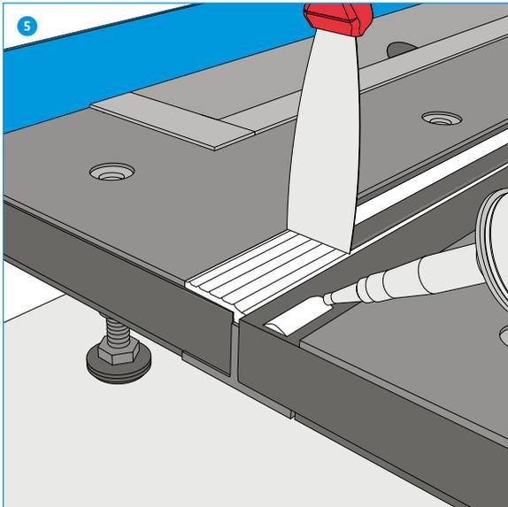
Mitgelieferter GABAG Montagekleber vollflächig über die Ausfräsung aufbringen und mit einem Spachtel abziehen.
