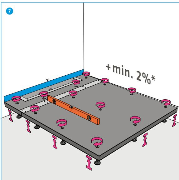
GABAG Duschboden von oben mit dem Inbusschlüssel nachjustieren.
