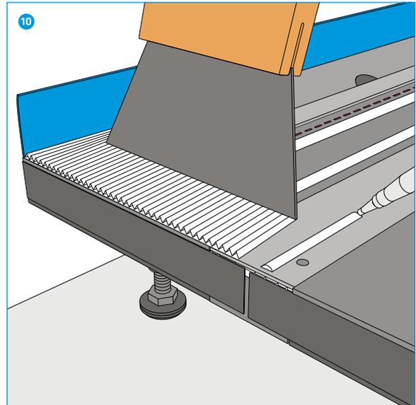
Oberflächenschutzfolie abziehen. Oberfläche Duschboden muss trocken, staub und fettfrei sein. Pro m<sup>2</sup> eine Dose Montagekleber aufbringen und mit einem Spachtel zügig vollflächig und lückenlos abziehen. Ablaufrinne am Rand 1 cm breit mit Montagekleber überziehen.
