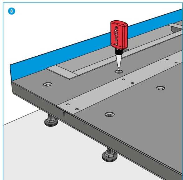
Kontrolle, dass sämtliche Schallschutzfüsse auf dem Boden aufliegen und Gefälle sowie Einbauhöhe sauber eingestellt wurde. In jedes Gewinde einige Tropfen des mitgelieferten Loctite geben.
