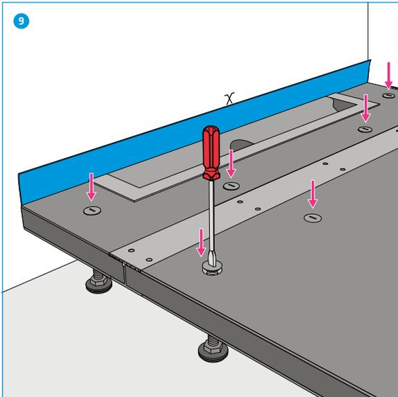
Dichtschauben bündig eindrehen und auf Anschlag leicht anziehen.
