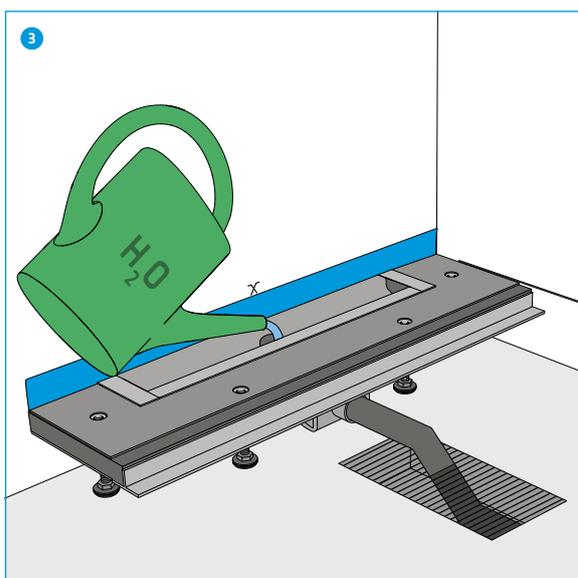
Ablaufkörper auf Stützen der Ablaufrinne satt aufstecken. Ablaufkörper an Ablaufrohr anschliessen und auf Dichtigkeit prüfen. Kontakt Ablaufkörper und Boden ist zu vermeiden. (Aus schallschutztechnischen Gründen ist der Ablauf zu isolieren und die Aussparung aufzufüllen)
