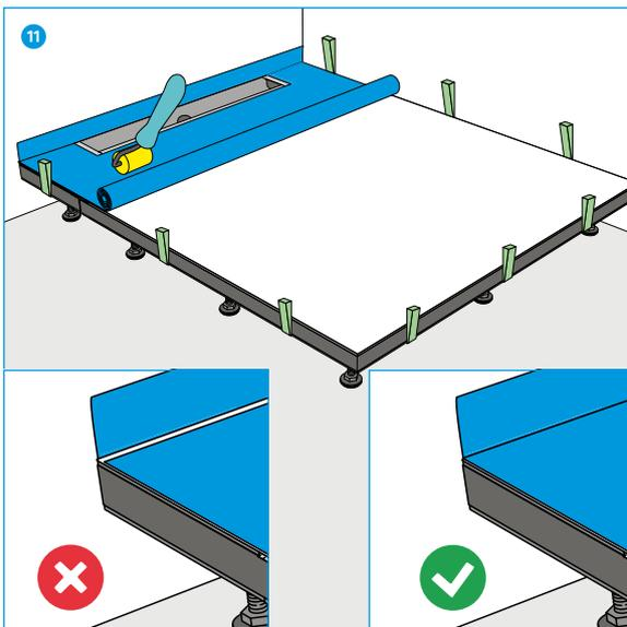
Mitgelieferte Dichtbahn falten- und wellenfrei aufkleben. Distanzstücke zur seitlichen Stabilisation zwischen Wand/Boden zu Duschboden einsetzen.
