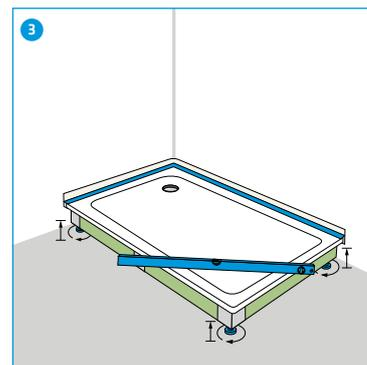
3 Wanne über die Schallschutzfüsse von Hand auf die gewünschte Höhe justieren und waagrecht ausrichten. TIPP: Vom Meterriss Einbauhöhe einmessen und Duschenwannenträgerhöhe voreinstellen.
