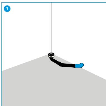
1 Kontrolle Nischenmass. Ablaufgarnitur an Ablaufleitung anschliessen und auf Position und Höhe der Duschenwanne ausrichten. Vor dem Versetzen am Wanntrand GABAG Wannprofil ISOPHONE® oder GABAG FLEXZARGE® anbringen.
