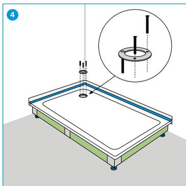
4 Siphon anschliessen und Dichtigkeitskontrolle durchführen.
