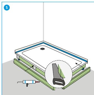
5 Boden-/Wandanschlüsse: Füllstück auf Mass zuschneiden und mit GABAG Montagekleber an Wannenträger bündig ankleben. Füllstücke dürfen nicht vorstehen.
