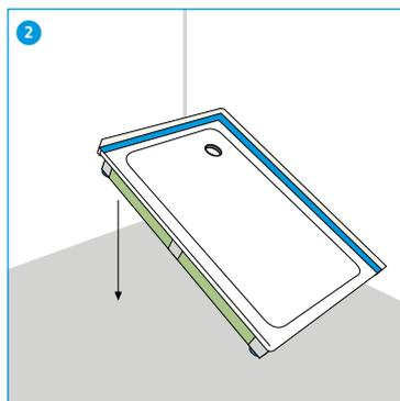
2 Ablaufleitung auf Boden des GABAG Duschenwannenträgers anzeichnen und Aussparung bei Rohrführungen wo nötig ausschneiden.
