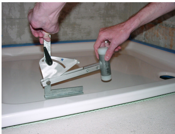
Messung mittels EMPA-Pendelfallhammer
